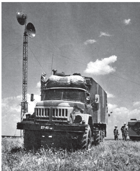
Рис.21. Радиорелейная станция Р-400М, развернутая вместо первоначальной Р-400 у каждого элемента «Системы «А». На переднем плане аппаратная машина и антенны направлений А и Б связи и передачи данных на антенной опоре «Унжа» ферменной конструкции
