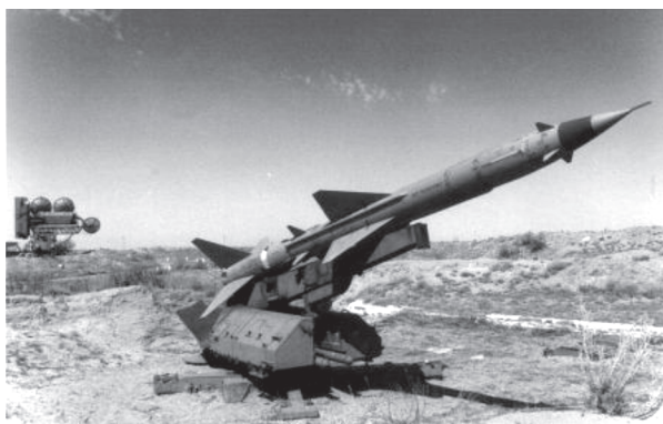
Рис.17. Зенитная управляемая ракета комплекса С-75 на пусковой установке. Вдали в левой части снимка видна приемо-передающая кабина управления с антеннами
