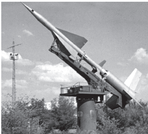
Рис.32. Противоракета В-1000 на пусковой установке с наклонным стартом
