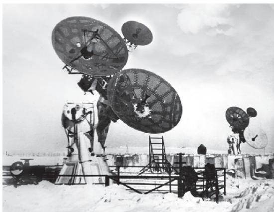
Рис.34. Комплекс из двух радиолокационных станций визирования противоракет, корректировки работы автопилота и передачи команд на их борт
